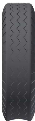
Falta de pressão
